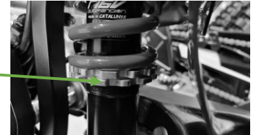
Figure 2 : Réglage de la pré-charge du ressort
