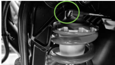
Figure 1 : Réglage hydraulique amortisseur
