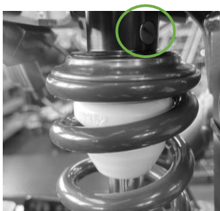
Figure 1 : Réglage rebond amortisseur
